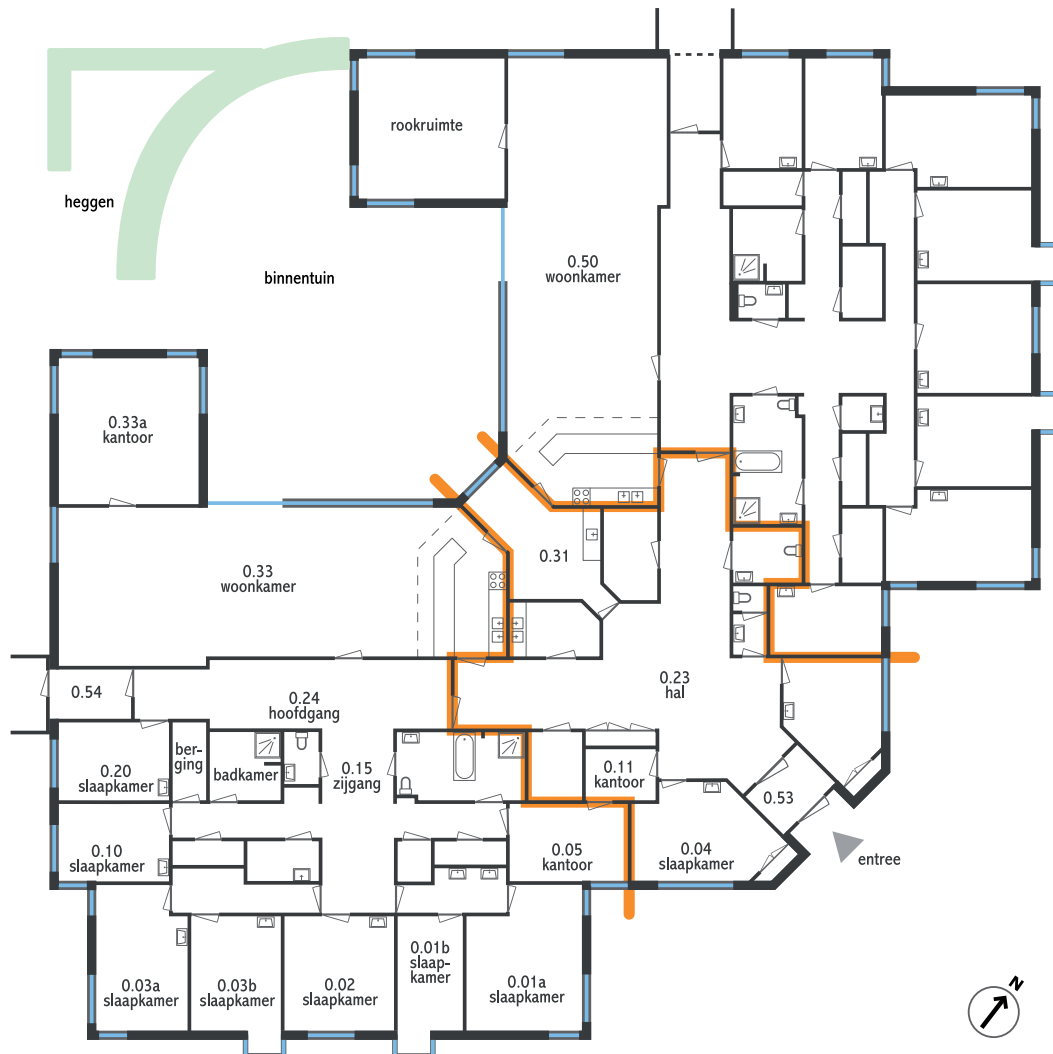
Figuur 13: Brandcompartimentering gebouw 755
