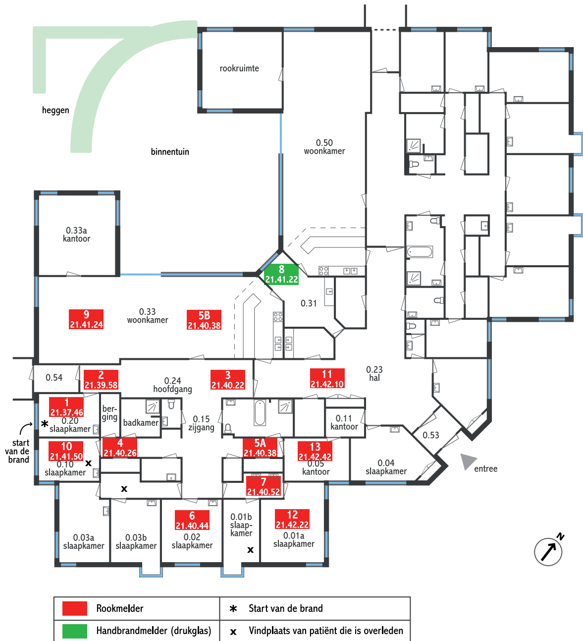
Figuur 6: Plattegrond met volgorde afgaan rookmelders, genummerd van 1 - 14 (gebaseerd op logboek brandmeldinstallatie van 25 maart 2011): nummer 8 is een handbrandmelder
